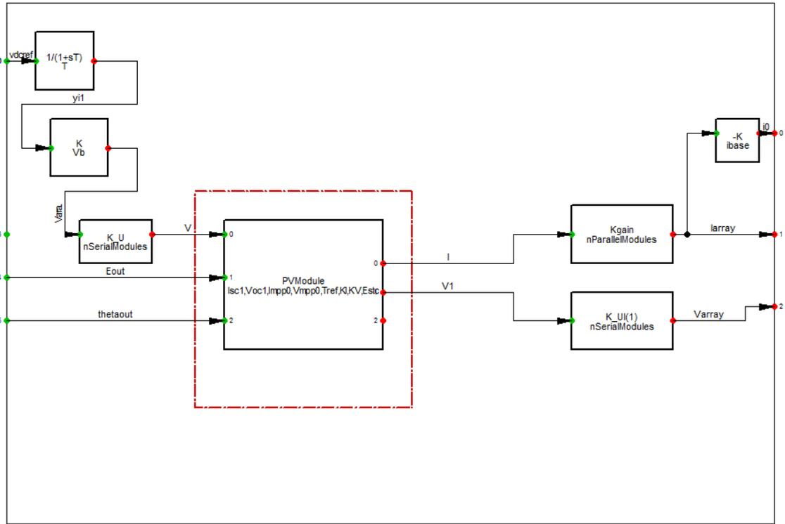
Fig. 8.3 PV module (slot 13)
