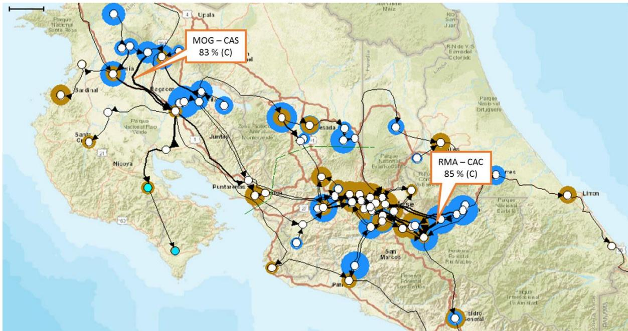
**Figura 76: Resultados del escenario final, año húmedo, estación húmeda, vientos altos / carga máxima: Líneas no sobrecargadas, las cargas más altas ocurren en las líneas Mogote - Canas y Río Macho - Cachí durante las contingencias dobles en las zonas respectivas.**
