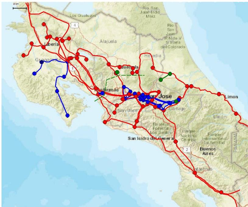
Figura 2: Red de transmisión de Costa Rica, con líneas de 230 kV marcadas en rojo y líneas de 138 kV en azul (las subestaciones marcadas en verde corresponden al sistema de distribución en 34.5kV).
